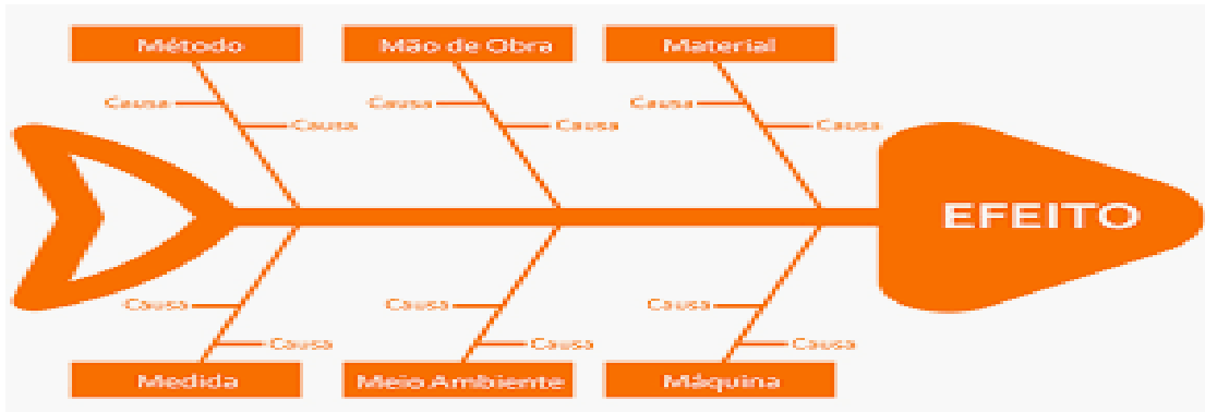
Figura 1. Exemplo de diagrama de Ishikawa, causa e efeito ou espinha de peixe
