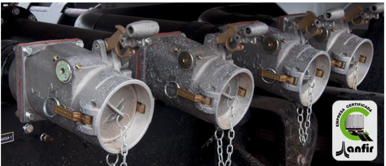
Figura 5 – “Bocas” de descarga de combustível
