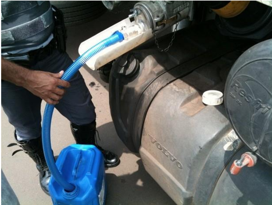
Figura 8 – Ilustração da prática de desvio de combustível utilizando equipamento caseiro
